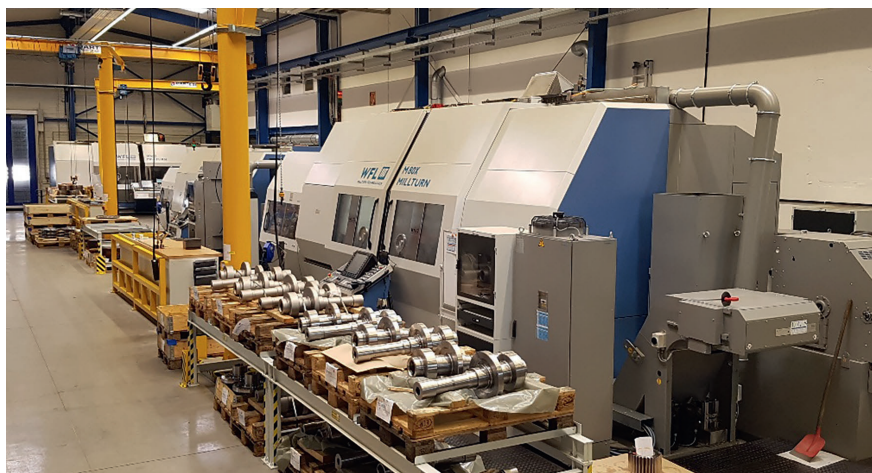
3 Auf einer M80X Millturn werden unter anderem verzahnte Hohlwellen für Getriebe gefertigt, mit einer Länge von 820 mm und einem Durchmesser von 350 mm © WFL
