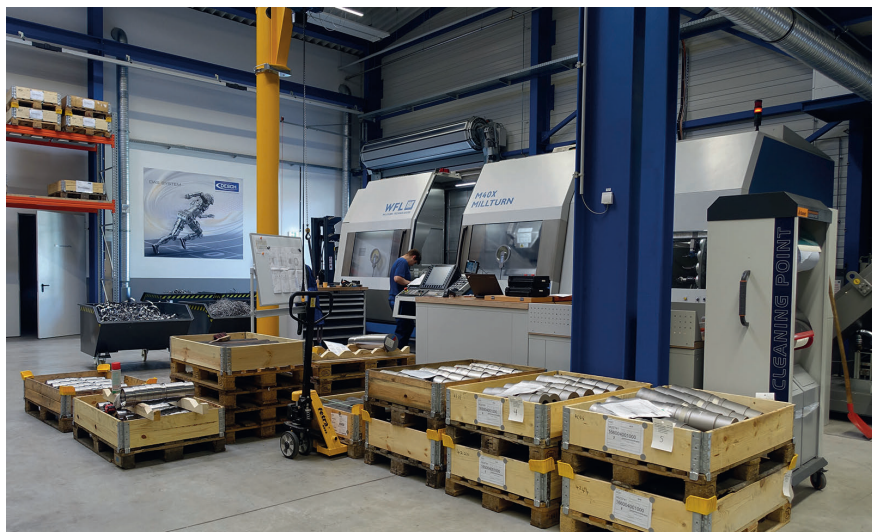
2 Die M40-Serie ermöglicht die Fertigung komplexer Futter- und Wellenteile bis zu 670 mm Umlaufdurchmesser. Neben überlegenen Leistungs- und Drehmomentwerten der Spindelantriebe sorgen gewaltige Vorschubkräfte auf allen Achsen für bestechende Dynamik und Produktivität © WFL
